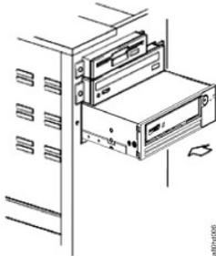
Si el sistema no utiliza hardware de montaje, compruebe que los orificios del chasis estén alineados con los orificios del lateral de la unidad de cintas (consulte la Figura 8).
