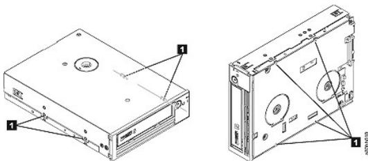
1. Orificios de montaje para tornillos M-3
